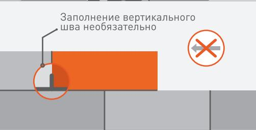
Примыкающий камень устанавливается «гребень в паз». Блоки укладываются пустотой вниз вертикально. Камни не сдвигать!
