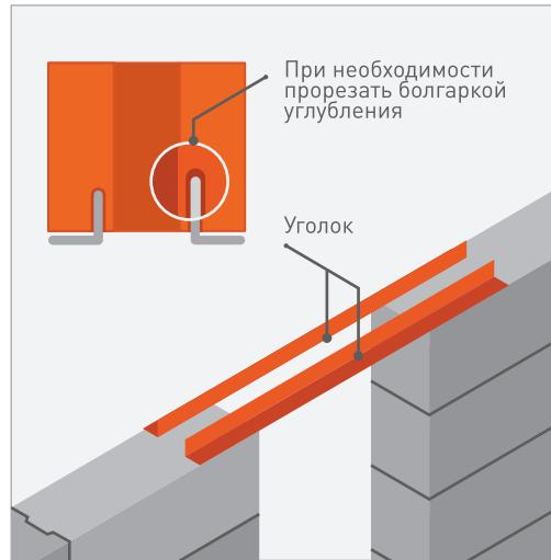
При использовании металлического уголка в качестве перемычки — дополнительно прорезать болгаркой существующие пазы!
