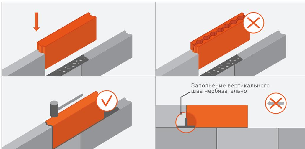
Примыкающий камень устанавливается «гребень в паз». Блоки укладываются пустотой вниз. Камни не сдвигать, а опускать вертикально вниз по пазу.
