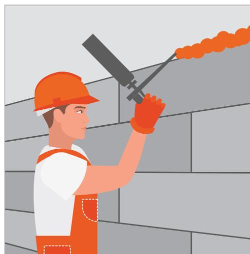
Если высота последнего ряда меньше высоты блока, распиливай блок так, чтобы остался зазор между стенкой и потолком 20-40 мм. Зазор запенивается, либо заполняется шнуром типа «Вилатерм», после чего зачеканивается раствором.
