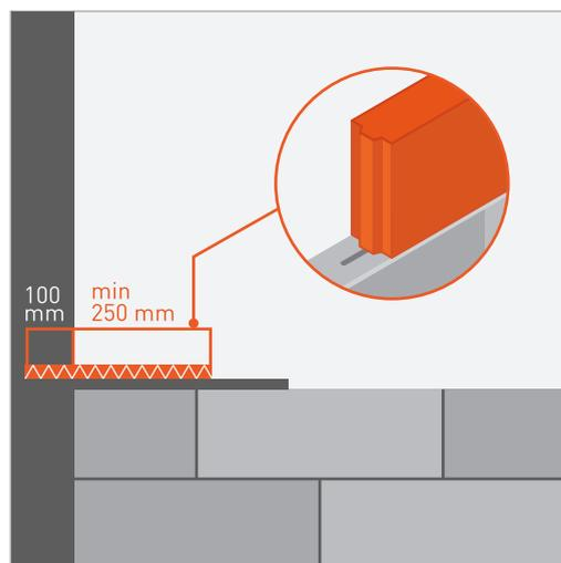
К несущим конструкциям крепить арматурой диаметром 8-10 мм, минимум в 2-х местах в каждом примыкании. Арматуру в стену заглублять на 100 мм, минимальный выпуск из стены 250 мм. На камне есть специальный паз для арматуры.
